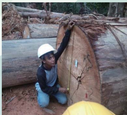
Mesurage des dimensions sur le parc à grumes
